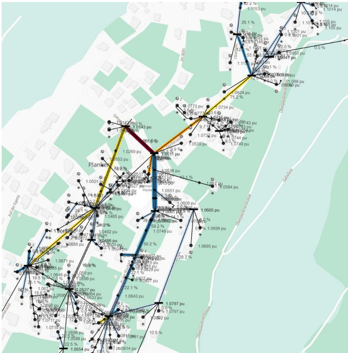
Abbildung 12 Berechnung der Leitungsbelastung bei PV-Vollausbau
