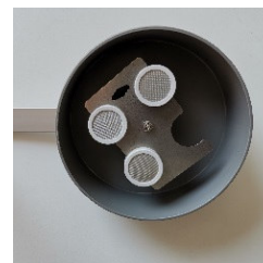
Abbildung 1 Fern-Passivsammlergehäuse von unten. Sichtbar sind drei Sammelplättchen in einer metallenen Halterung.
