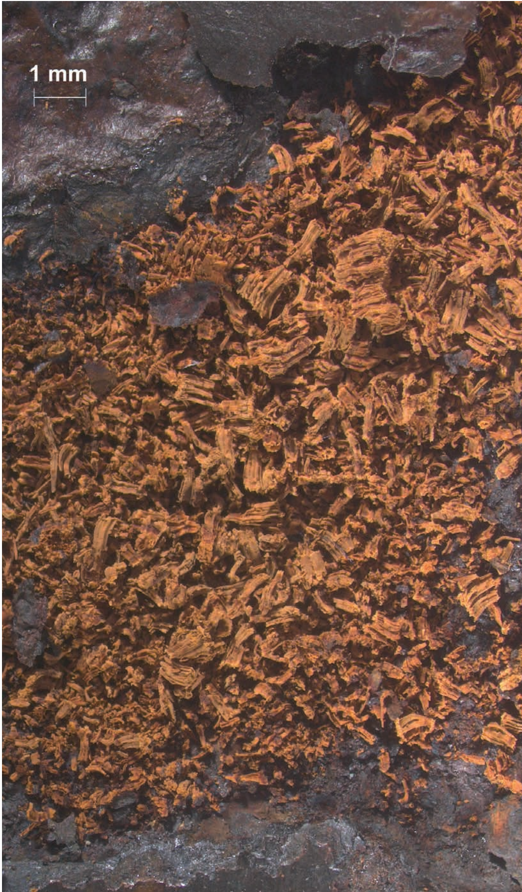
Abb. 2: Mikroskopaufnahme der Akaganeitkristalle unter einer abgeplatzten Scholle am Sax.
