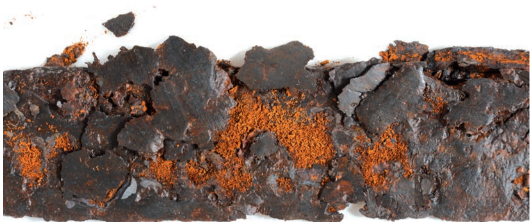
Abb. 1: Durch die Bildung von Akaganeit abplatzende Schollen an der Klinge des alamanischen Saxes (Inv. Nr. O 0244/0003) aus Eschen.
