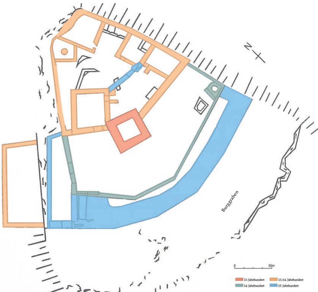
Abb. 33: Schellenberg, Obere Burg. Schematischer Bauphasenplan.
