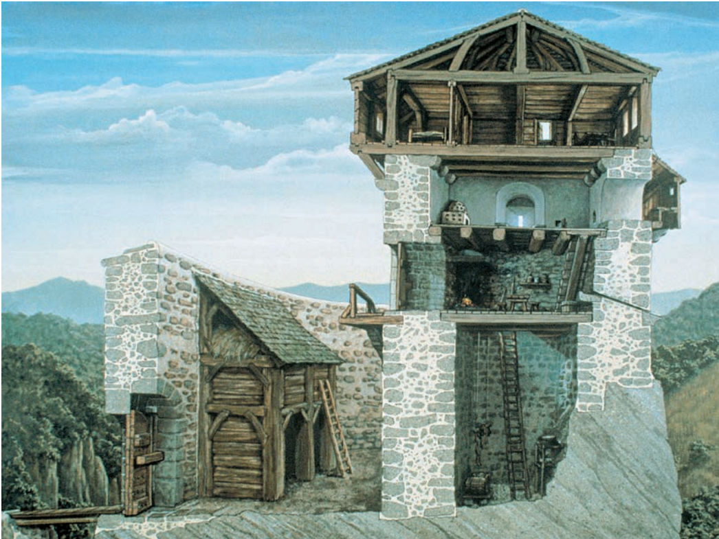
Abb. 32: Schnitt durch einen Wohnturm (Idealdarstellung): Von oben zugängliches Vorratslager im Erdgeschoss; Hocheingang, Küche und Schüttstein im 1. Obergeschoss; Wohnraum mit Ofen, Fensternische und Aborterker im 2. Obergeschoss; hofseitig vorragender Obergaden mit Schlafräum und Stube im 3. Obergeschoss.
