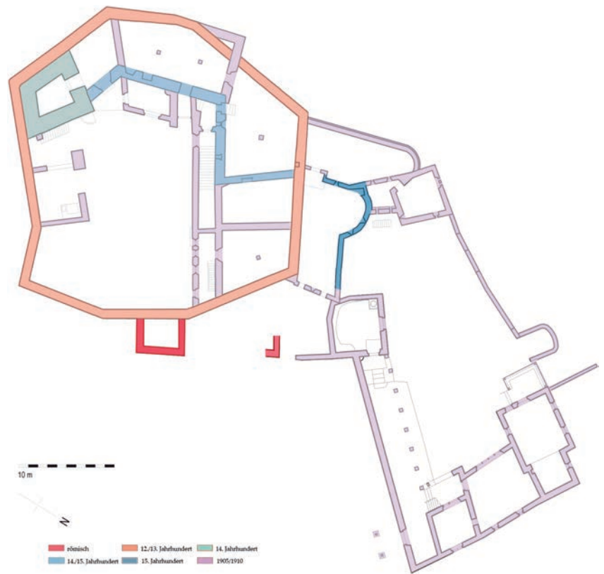
Abb. 16: Balzers, Burg Gutenberg. Grundriss mit Rekonstruktion der Bauphasen anhand archäologischer und baugeschichtlicher Untersuchungsergebnisse sowie der Auswertung und Interpretation historischer Schrift- und Bildquellen.
